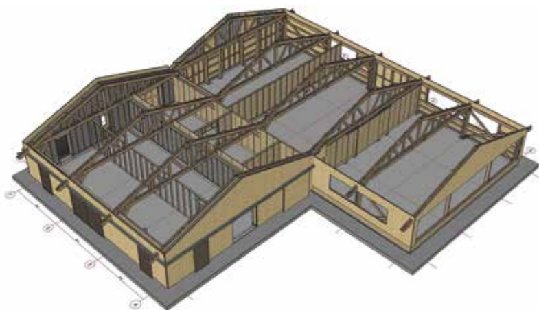
// Vue d'ensemble de la structure primaire en chêne //
