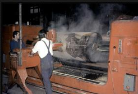
Traçage d'un repère de niveau sur une grume dans la dérouleuse
